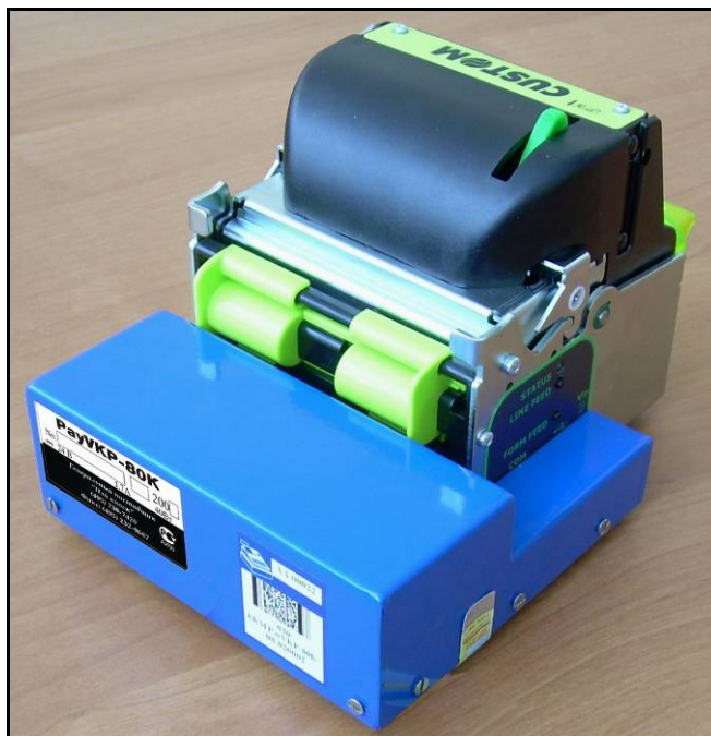
Рисунок 17 – Принтер, установленный на основание фискального блока.
